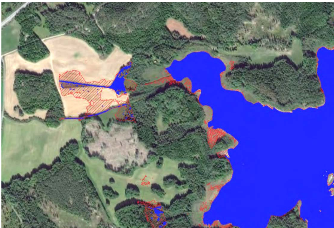
Figur 27. Översvämningsskänslig åkermark vid Toverum (väg 40 syns i övre vänstra hörnet). Blått visar Yxern vid vattenstånd +92,50, rödstreckat område visar mark med dålig bärighet (Calluna, 2017).
