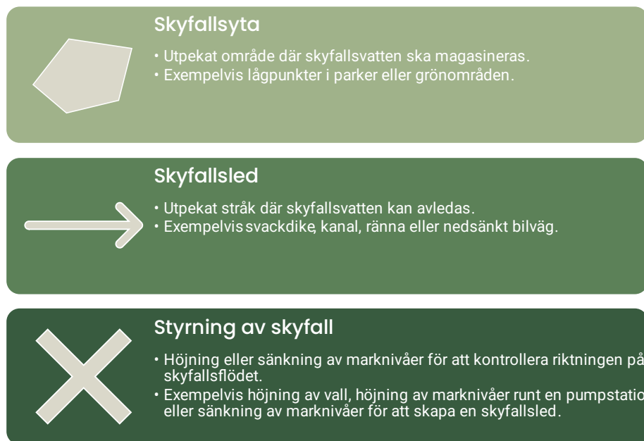
Figur 11. Schematisk illustration av effektiva skydd mot skador orsakade av översvämning vid skyfall.
