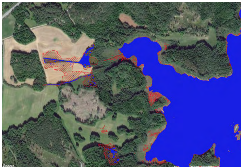
Figur 11. Översvämningskänslig åkermark vid Toverum söder om väg 40 (vägen syns uppe till vänster). Blått är 92,25 möh i RH00 och rödstreckat område är de låglänta områden som då är så sanka att de har för dålig bärlighet för en traktor.
