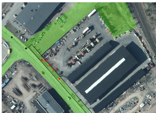
Figur 2. Dag- och dränvatten till befintlig dränledning
