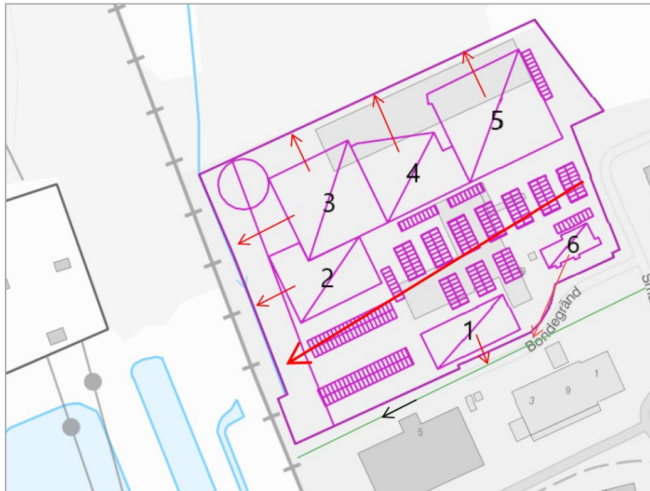
Figur 6. Skiss över föreslagen dagvattenlösning för Flundran 20 utifrån Plankarta samrådshandling 2022-06 (lila linjer visar byggnader, 1 till 6, och parkeringsplatser mellan byggnaderna). Riktningspilarna visar avledning från takytorna som röda pilar, generell riktningspil för ytavrinning från parkering som tjockare röd pil och ungefärligt läge för dagvattenledning söder om fastigheten som grön linje.
